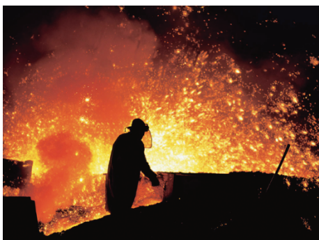
图3. 在钢铁厂高炉喷出的火花中，铁矿石和焦炭正在发生反应，生成生铁和二氧化碳。在最常见的炼钢过程中，这一步产生的二氧化碳最多。来源：Třinecké železářny, 已获引用许可。
