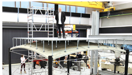
图2. 英国巴斯大学的Paul Shepherd及其同事设计的这种弧形混凝土楼板所产生的温室气体排放量，比传统楼板少了60%。Shepherd站在置于该楼板上方的地板上。来源：巴斯大学，已获引用许可。
