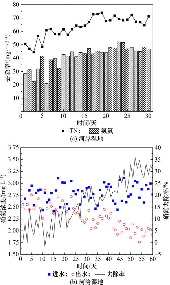
图3 新型河岸湿地与河湾湿地净化技术对氮的去除效率
