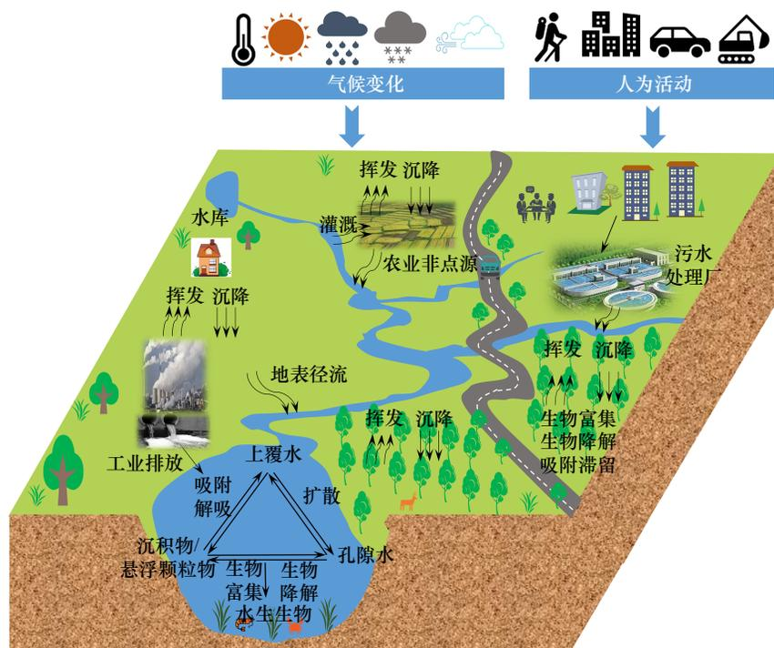
图1 污染物在流域水土环境中的跨介质迁移过程
