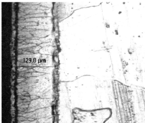
图11 纯铁表面处理后显微组织
