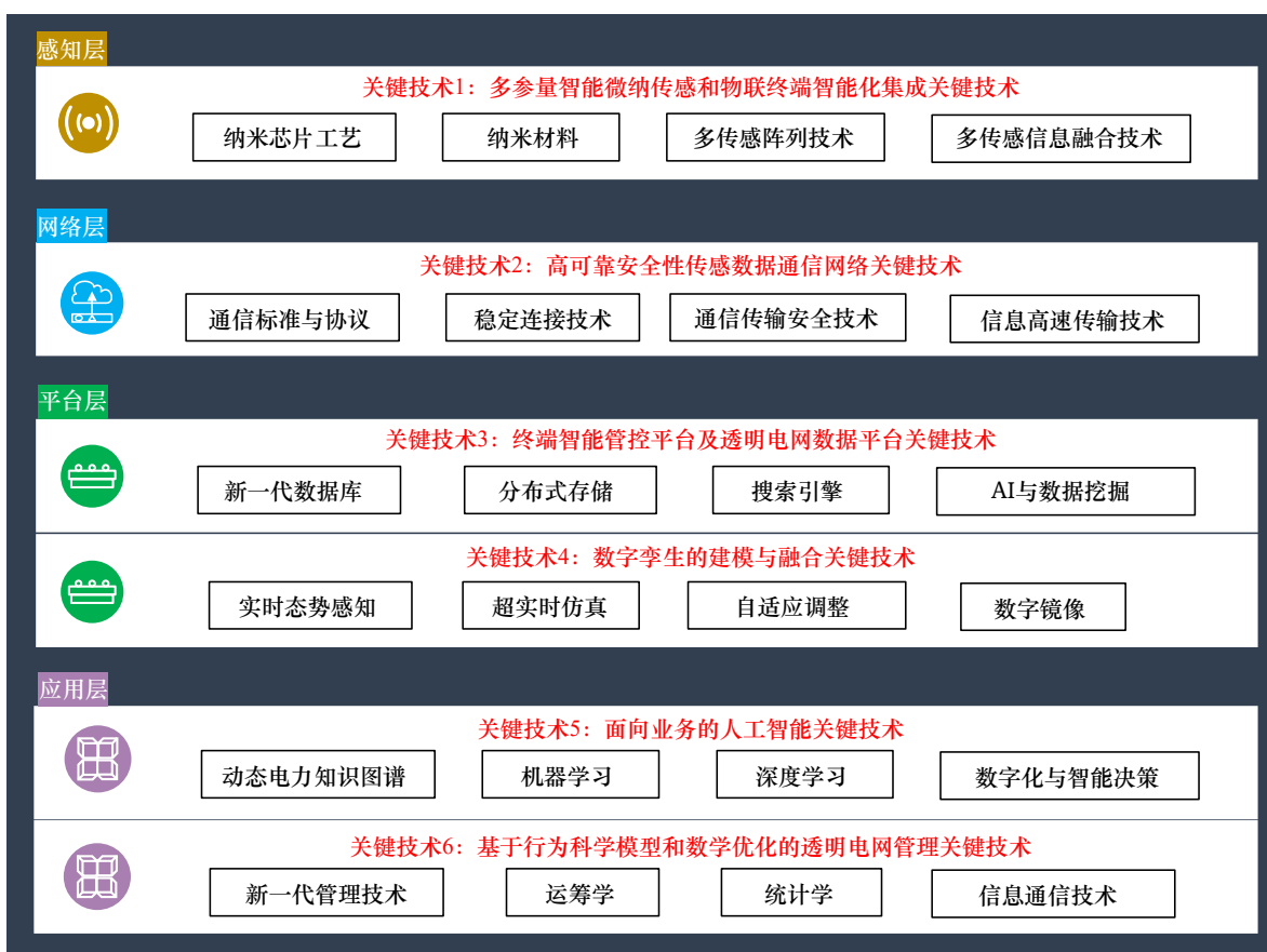
图4 透明电网技术体系总体框架
