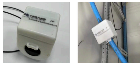
图7 “五合一”智能电气量集成传感器
