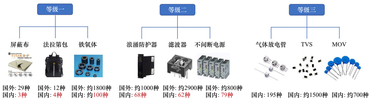
图4 电磁核心防护器件的分级及相应模组产品情况
