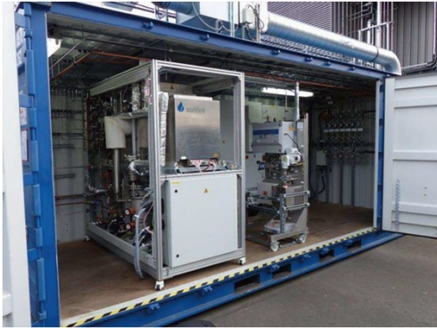
图 13. Sunfire GmbH 公司开发的共电解示范系统[99]。
