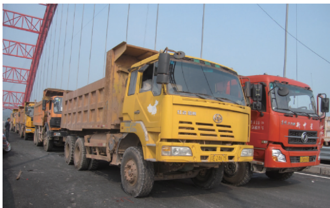
图13. 合江长江一桥成桥荷载试验。
