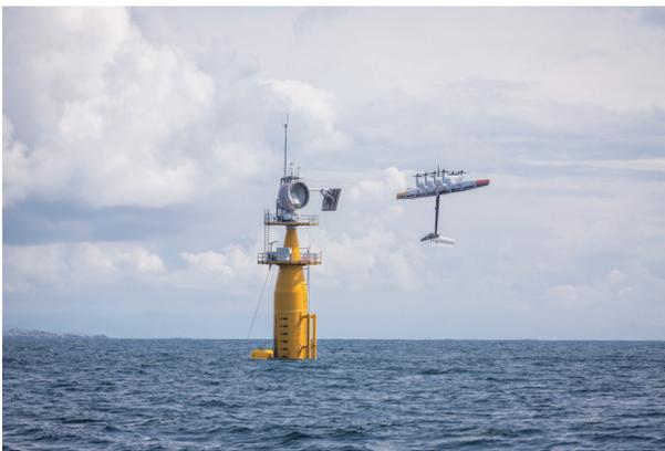
图1. 2019年8月，在挪威海岸附近进行的飞行试验中，由Makani制造的600 kW的能源风筝原型悬浮在空中，它自动从海上获取风能。风筝是通过一根系在它26 m长的机翼上的绳索连接到它的浮动基站上的，这根绳索位于风筝原型结构顶部附近的滚筒线轴上。风筝降落并从倾斜板起飞到达滚筒右侧，滚筒正好与它的机翼下面的一排电动发电机槽相吻合。来源：Makani技术，经许可。
