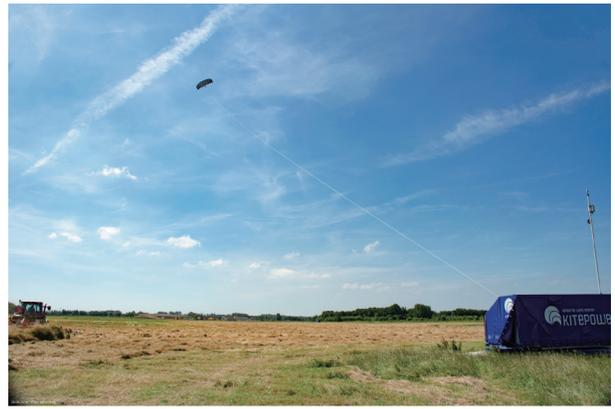
图2. 2018年6月，荷兰前海军空军基地Valkenburg的一个地面发电AWE系统在一片农田上空放飞了风筝，该基地现在是欧洲的一个包括AWE和无人机在内的无人驾驶航空技术测试和培训中心[15]。当风筝离开它的基站（右下角）时，为了有效地收集风能，这个面积为25 m<sup>2</sup>的自主风筝在横风圈或按图形“8”进行演习，将最大风力转移到拉风筝的绳索上。当它解开绳索缠绕时，绳索带动发电机旋转，并将这种风力发电转化为电力。来源：Kitepower BV，经许可。
