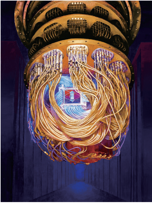
图1. 艺术家通过将谷歌公司的Sycamore处理器嵌入到一个低温恒温器设备中对其进行再现，该设备可以将处理器的量子位元冷却到绝对零度以上的几分之一。低温有助于防止噪声干扰量子位元。图片来源：Forest Stearns, Google AI Quantum Artist in Residence (CC BY-ND 4.0)。
