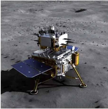
图2. 嫦娥五号着陆器和上升器矗立在吕姆克山（Mons Rümker）附近着陆点的月球表面上。上升器将1.7 kg月球物质送入轨道，然后将其转移至嫦娥五号的返回舱，以便返回地球。图片来源：China News Agency (CC BY 3.0)。
