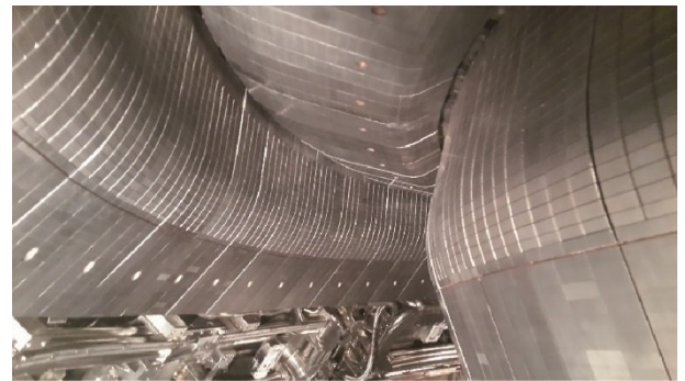
图5. 类ITER钨串水冷偏滤器。
