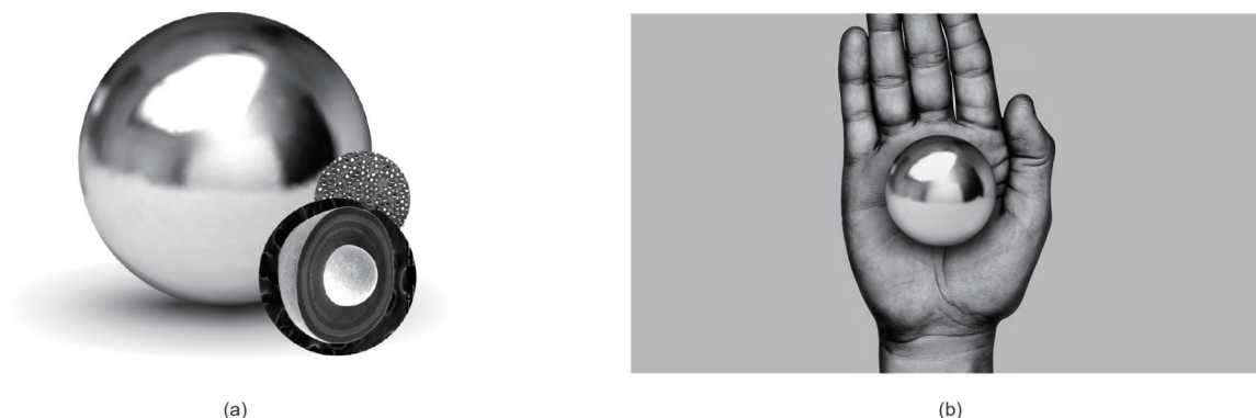
图1. (a) 镶嵌数千个TRISO粒子形成的燃料球(图中靠后位置)。截面图(图中靠前位置)显示了单个粒子的多层结构,其中高温碳层、碳化硅层、碳缓冲层构成保护层,覆盖于中心层二氧化铀或铀碳氧化物上。(b) 单颗燃料球的大小。来源: X-energy (公共来源)。
