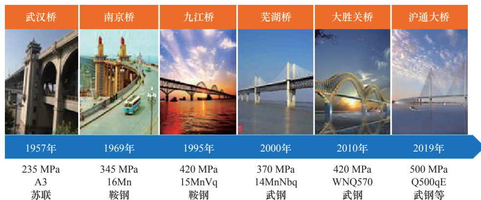
图 1 中国桥梁钢的发展历程
