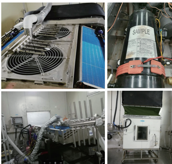
图 11 电动客车低温空气源热泵样机以及测试装置
