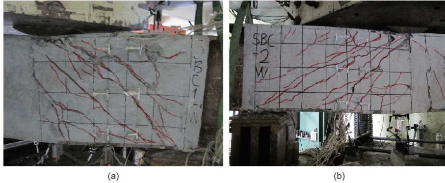
图6. 试件SBC1和SBC2的失效模式。(a) SBC1 ; (b) SBC2。
