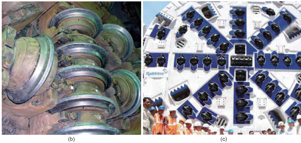
图5. (a) 示意图；(b)、(c) 中心四刀布置图（美国罗宾斯公司提供）。
