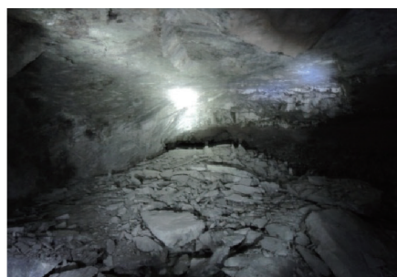
图7. 红透山铜矿开采扰动诱发的岩爆。(a) 矿体形状; (b) 1999年5月18日斜坡道内的岩爆; (c) 2005年1月8日在矿房内发生的岩爆。
