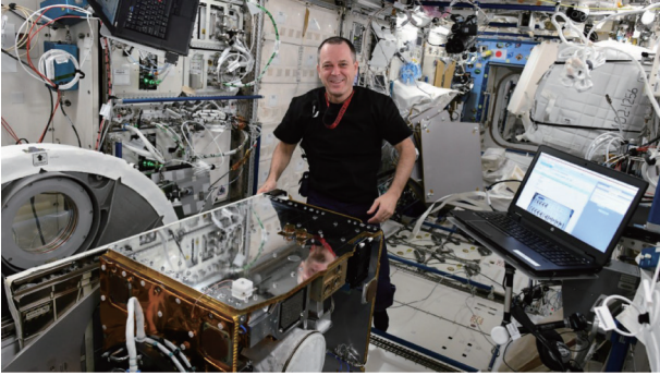
图1. RemoveDEBRIS卫星是国际空间站上部署的最大的卫星，由NASA宇航员Ricky Arnold送入气闸中。该卫星成功地完成了四个任务中的三个，以测试从轨道上清除碎片的技术。图片来源：NASA/NanoRacks。
