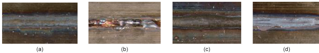
图6. 四种焊接状态定义。(a) 焊接良好；(b) 崩裂；(c) 驼峰；(d) 咬边。
