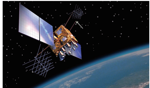
图1. 如图所示，这颗GPS IIR-M卫星是2005—2009年发射的系列卫星之一。它与美国GPS卫星网络中的约30颗其他GPS卫星一道，每天绕地球两圈，向地面传送时间和轨道数据，以使接收器能够精确地确定它们的位置。Credit: United States Government (public domain)。
