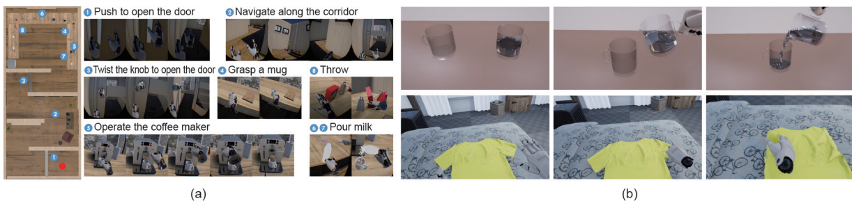
图36. VRGym——虚拟环境作为大型任务平台的示例。(a) 在此平台内, 人类或虚拟智能体都可以在虚拟场景中执行各种操作, 并评估任务执行的成功程度。(b) 除刚体模拟外, VRGym还利用最先进的游戏引擎支持逼真的实时流体和布料模拟。图片摘自参考文献[384], 已得到Association for Computing Machinery, © 2019的许可。
