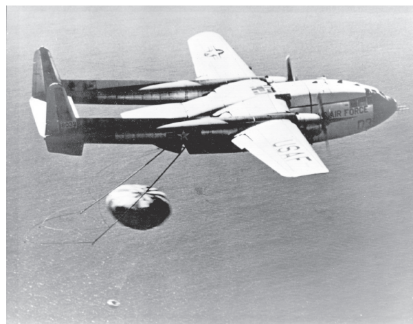
图2. 1960年8月，美国空军飞机试图用“桶抓”方式取回“日冕”卫星释放的装有胶片的太空舱。太空舱悬挂在飞机打算进行捕获的降落伞下方。图片来源：US Air Force (Wikimedia, public domain)。
