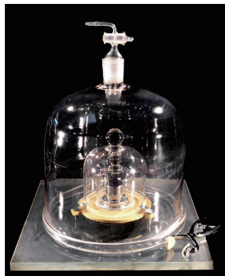
图1. 自1889年以来，全球范围内，千克这一质量单位是由一个被称作Le Grand K的矮形铂合金圆柱体所定义的。自Le Grand K被锻造完成后，人们便将它存放在巴黎郊外的一个地下室的3个玻璃钟罩下。图片来源：BIMP。
