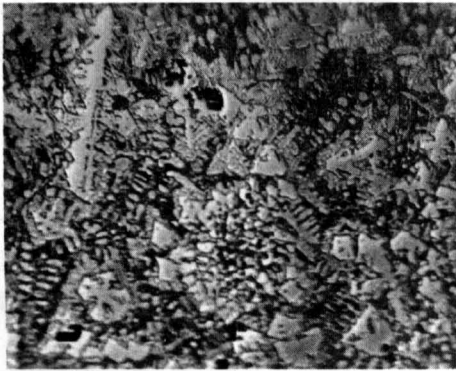
图 1 WC 堆焊层原样显微图片 (×600) Fig.1 Micrograph of weld deposited WC
