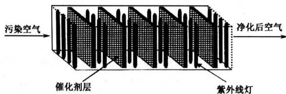
图 2 空气净化器内部结构
