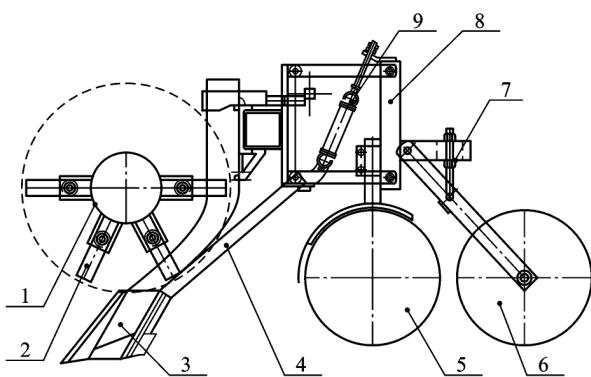
1—甩刀轴;2—甩刀;3—破茬尖角开沟器;4—肥管;5—双圆盘开沟器;
