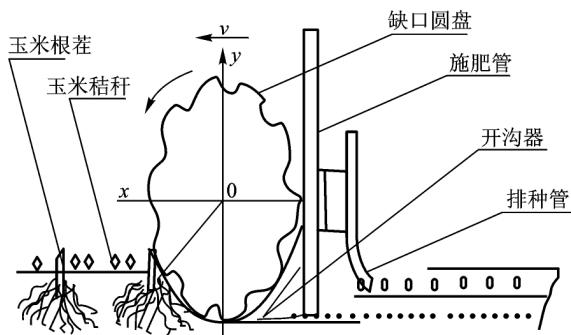
图 6 缺口圆盘切断秸秆、根茬及施肥下种示意图
