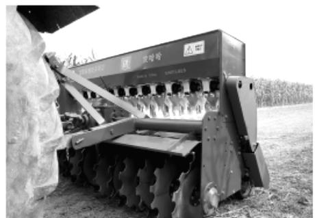
图5 2BMXD-12型斜置驱动圆盘免播机
