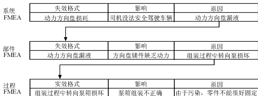
图 2 在某一级别最终失效模式视为更高级别(下一个更高的影响)的失效原因示意图
