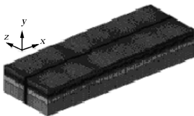
图 18 复合土层段有限元模型
