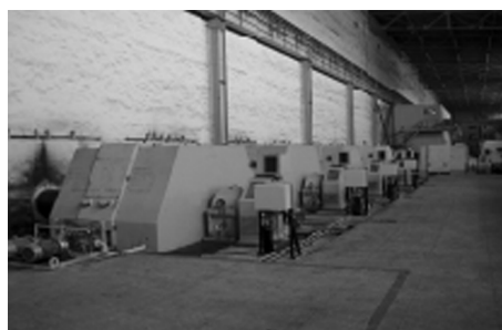
图 2 国产第一套热连轧机传动交流调速系统 Fig. 2 The first domestic hot strip mill drive AC variable speed system
