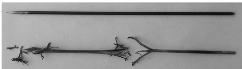
图8 爆裂后的钨针与原钨针对比
