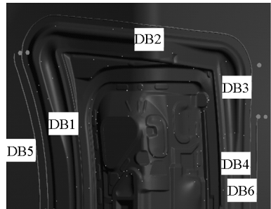
图9 行李箱盖内板拉延筋布置图
