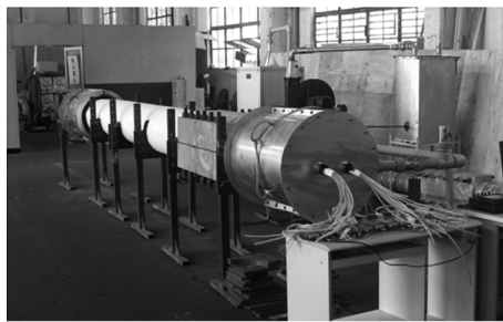
图1 泰州大桥主缆模型试验
