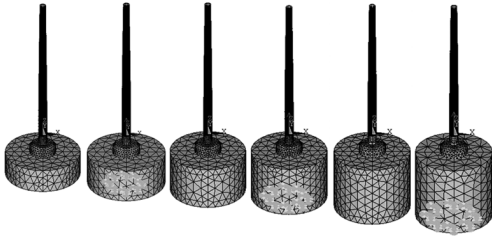
图 2 不同冲刷深度条件下的结构几何模型(流固耦合)
