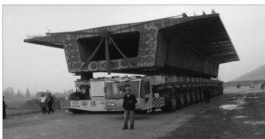
图9 全液压 TLC900 型轮胎式运梁车
