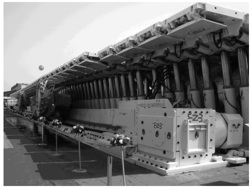
图5 中煤集团承担的国家科技计划重大项目——特厚煤层大采高综采成套设备
