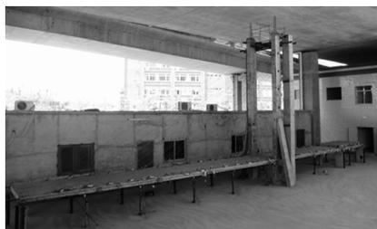
图5 模型桥成桥状态
