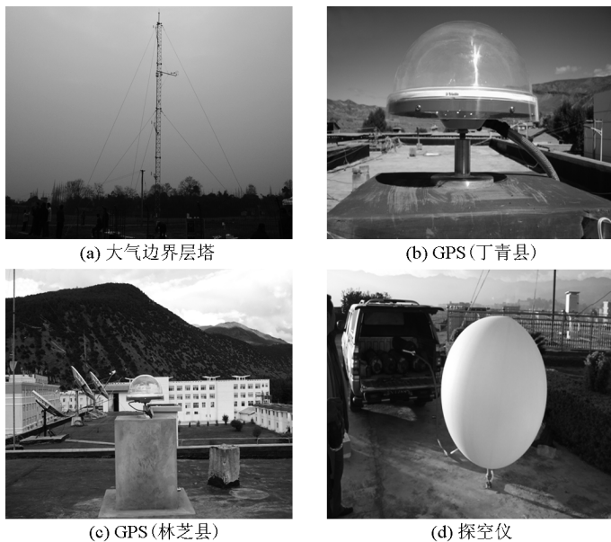
图7 观测中所使用的大气边界层塔、GPS 大气水汽观测仪和探空仪
