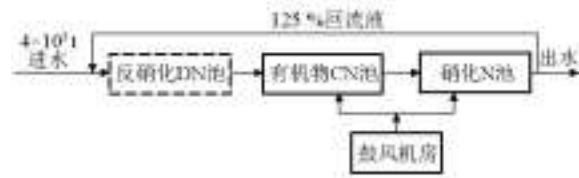
图12 前置反硝化曝气生物滤池工艺流程图 Fig.12 Process of pre-denitrification BAF
