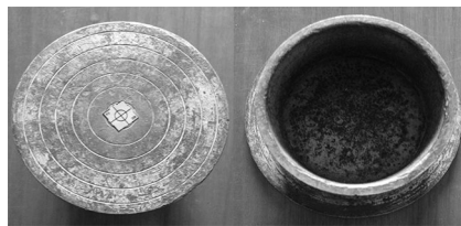
图1 中心带照准标志的圆柱螺帽型定位装置
