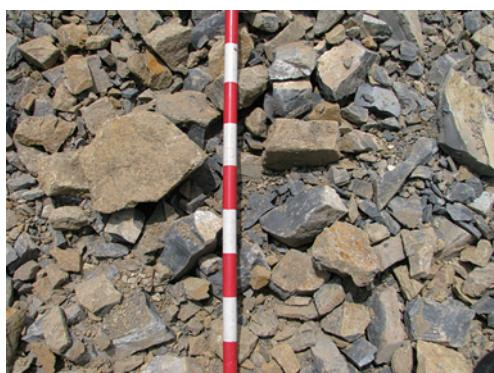
图7 分段装药结构爆后效果
