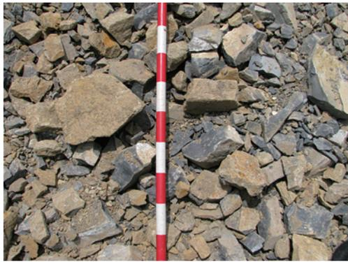
图7 分段装药结构爆后效果
