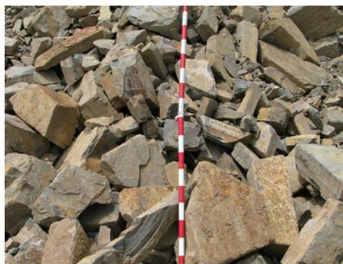
图6 连续装药结构爆后效果
