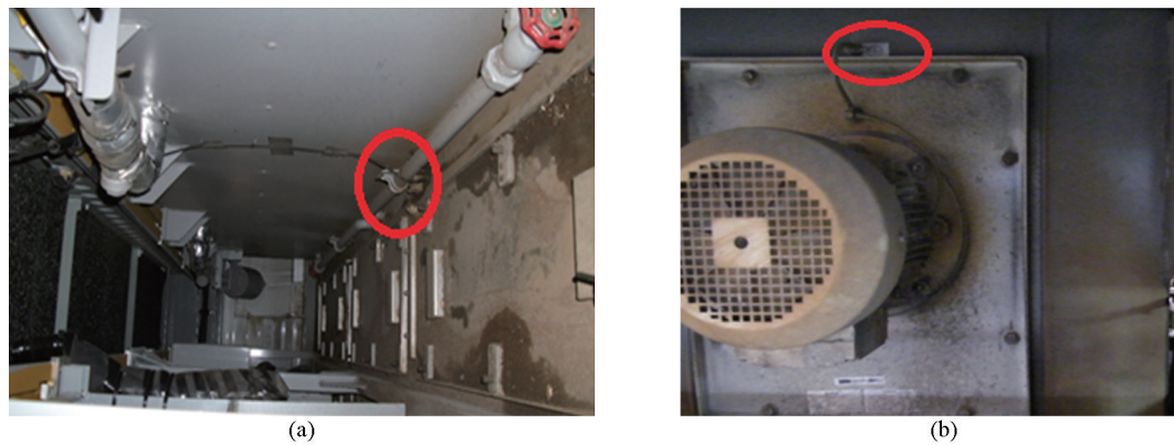
图2 某一高速列车车下水箱与换气装置振动加速度检测图
