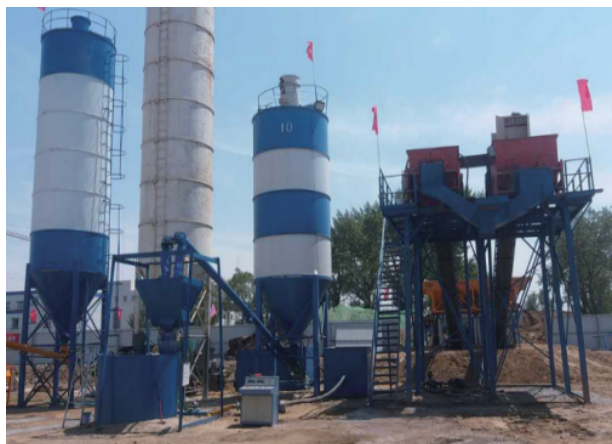
图 15 预拌固化土的制备和拌和系统
