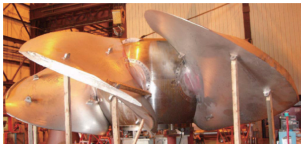
图5 瓦纳普姆水电站鱼类友好型水轮机
