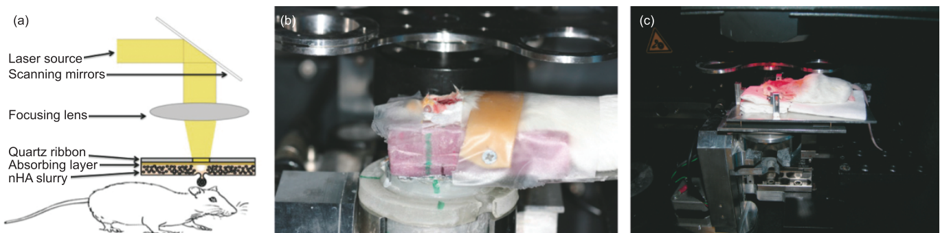
图 11. 使用 BioLP 的活体打印。(a) 工作设置示意图；(b) 放置在特定夹具内的小白鼠；(c) 生物打印过程。(摘自参考文献 [143,144])
