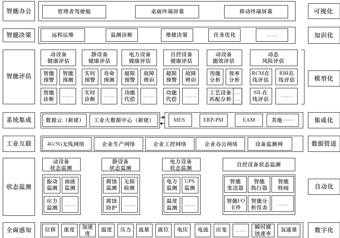
图1 动静电仪设备本质安全可靠与监管智能化设计框架图
