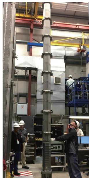
图7. 全尺寸行波堆制造验证燃料组件。
