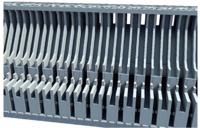
图3. 重力坝泄洪坝段三维示意图。
