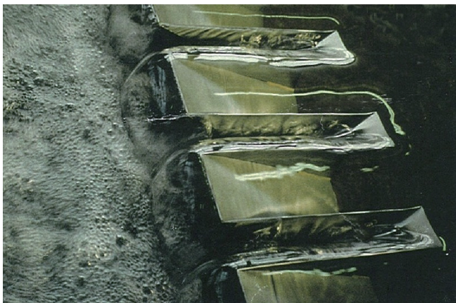
图2. P.K. Weirs模型测试。
